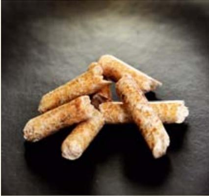
Für den Brennstoffbedarf privater Haushalte haben sich Holzpellets mit 6 mm Durchmesser durchgesetzt. Für den Brennstoffbedarf in leistungstärkeren gewerblichen und kommunalen Biomasseanlagen werden auch Holzpellets mit 8 mm Durchmesser hergestellt. Je nach Anwendungszweck und gewählter Matrize können Presslinge mit beliebigem Durchmesser hergestellt werden, ab einem Durchmesser von 4 cm und bei eckigen Presslingen spricht man von Briketts.
